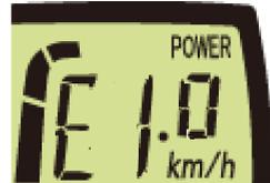
In diesem Fall sollten Sie das Antriebssystem nochmals mit der POWER Taste aus und wieder einschalten ohne die Pedale zu belasten – damit sollte der Fehler behoben sein.
