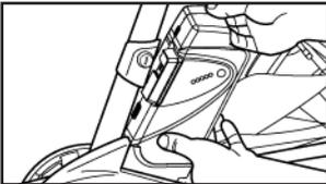
Setzen Sie den Akku, von oben kommend, schräg in den Akkuhalter ein
